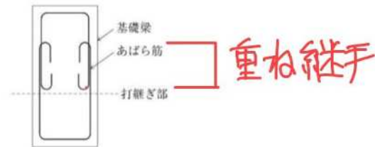
図-1 基礎梁の断面図
